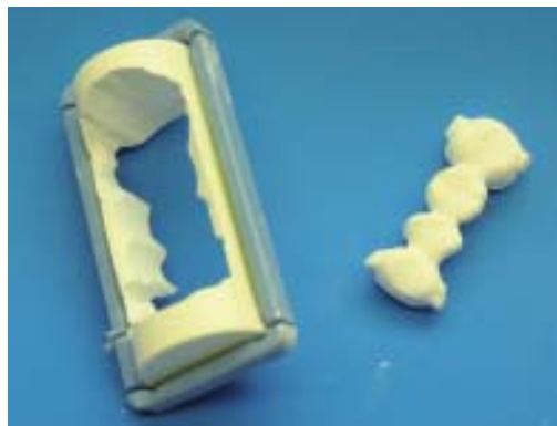
Abb. 3: Brückengerüst nach dem Fräsprozess im Weißzustand und Reste des Zirkoniumdioxidrohlings.
