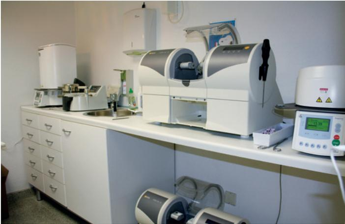
Abb. 3: Die CEREC MC XL Schleifeinheit.
